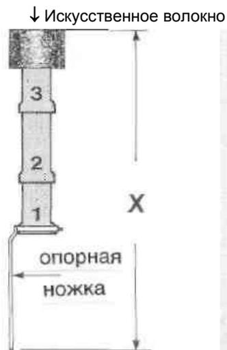
**1** Установите опорную ножку в нижнем соединении трубы. Соедините все трубы, смазав их предварительно клеем. **Внимание!** Верхней трубой должна быть труба 3 с "воротником". Вороник необходим для того, чтобы удерживать на месте искусственное волокно. Установите искусственное волокно на трубе 3 и закрепите его проволокой.
